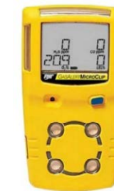
Figuur 7 – voorbeeld van een LEL meter.
